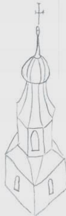
Achteckiger Helm mit Zwiebelhaube
