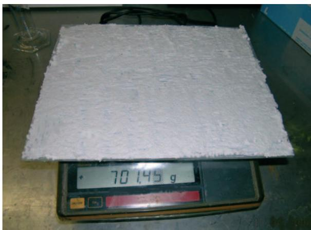
**Bild 19:** Für die Prüfkammermessung vorbereitete Kunstharzfertigputz-Probe auf einer Glasplatte in der vom Hersteller empfohlenen Schichtdicke: Hier eine Gewichtskontrolle der beschichteten Glasplatte
