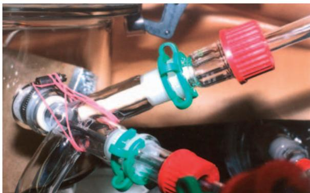
**Bild 11:** Ein mit Polyurethanschäum selbst bestücktes Sammelröhrchen (weiß im Bild) für die Adsorption von SVOC, hier während der Probenahme.
