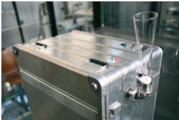
**Bild 13:** Probenahme- und Probendarbietungsgerät Air Probe. An der rechten Seite ist ein Bewertungstrichter aus Glas erkennbar. Für die Geruchsmessung der gleichmäßig ausströmenden Luftprobe hält der Proband seine Nase über den Trichter.
