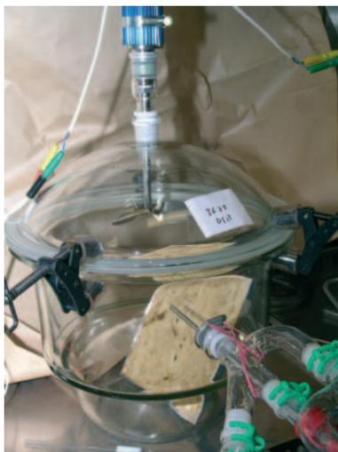
**Bild 8:** Emissionskammer (Exsikkator) mit der Materialprobe einer Holzspanplatte, das Fassungsvermögen beträgt 20 Liter.
