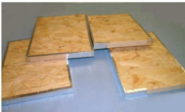
**Bild 21:** Für die Prüfkammermessung vorbereitete OSB-Proben
