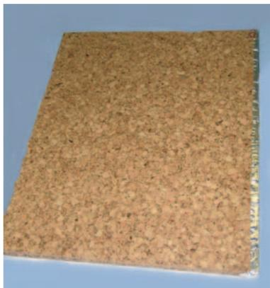
**Bild 20:** Für die Prüfkammermessung vorbereitete Probe von einer Korkbodenplatte
