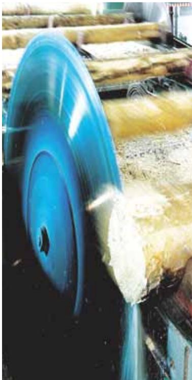
Produktionsanlage bei binderholz: Zuschnitt der Baumstämme.
