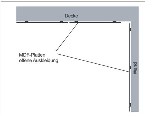
MDF-Plattenverkleidung, grundiert und vorbereitet für bauseitige Tapeten, Foto, Textil oder Strukturputz-Auftrag. Vorzüglich geeignet für versteckte Verkabelungen oder besondere Applikationen.
