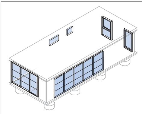
Front Süd+West, Alu-Fenster mit Dreh/Drehkipp Beschlag. Frontseite Ost, Aluminiumglasung mit festem Unterteil und mit Dreh/Drehkipp Fensterflügel, Alu-Hauseingangstüre mit 3-fach Verriegelung und PZ Schloß.
