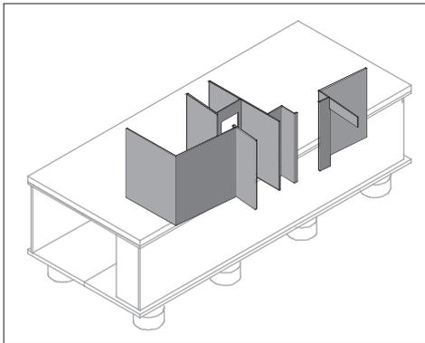
Massivholz Zwischen-Wandsystem 51mm stark nach dem Grundriss des Modulhauses. Oberfläche vorgefertigt für MDF Beplankung oder Rigips Verkleidung.
