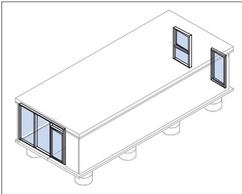
Frontseite Süd, Aluminiumfenster mit Dreh/Drehkipp Beschlag. Frontseite Nord, Aluminiumglasung mit festem Unterteil und mit Dreh/Drehkipp Fensterflügel, Alu-Hauseingangstüre mit 3-fach Verriegelung und PZ Schloß.
