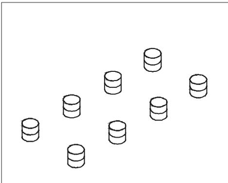
Statisch berechnete Punktfundamente mit Stahlbewehrung in Betongüte C20/25-XC2. Größe berechnet für tragfähiges Erdreich mit einer angenommenen Bodenpressung von 100kN/m<sup>2</sup>.
