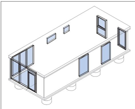
Front Süd+West, Alu-Fenster mit Dreh/Drehkipp Beschlag. Frontseite Nord, Aluminiumglasung mit festem Unterteil und mit Dreh/Drehkipp Fensterflügel, Alu-Hauseingangstüre mit 3-fach Verriegelung und PZ Schloß.
