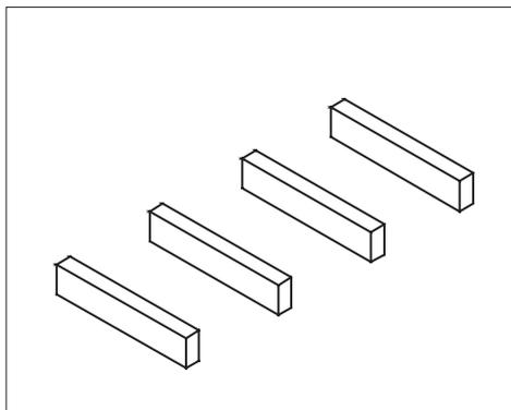
Statisch berechnetes Betonfundament mit Stahlbewehrung in Betongüte C20/25-XC2. Größe berechnet für tragfähiges Erdreich mit einer angenommenen Bodenpressung von 100kN/m<sup>2</sup>.
