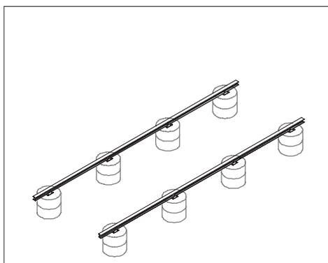
Statisch berechnete, feuerverzinkte Stahlkonstruktion mit vorgefertigten Bohrungen zur Aufnahme der Modulhaus-Bodenplatte. Alle Stahlträger mit Schraubplatten, vorgefertigt zur Verbindung mit dem Fundamenten.
