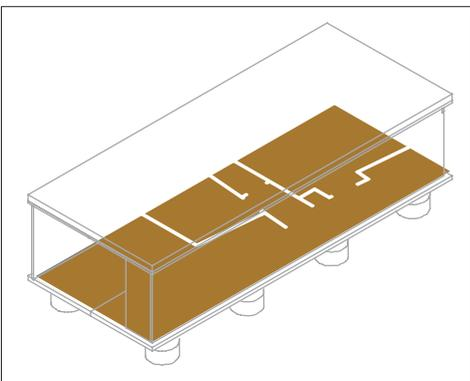
Fußbodensystem auf PU- Bodenkonstruktion, für integrierte Verlegung der Versorgungsleitungen wie Elektro, Wasser, Abwasser, Heizung, EDV oder sonstige Medien.
