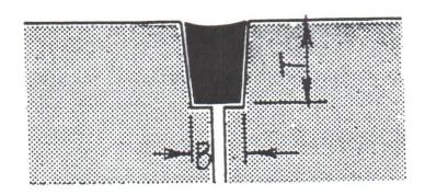
Abb.: Grundsätzliche Fugenausbildung bei plastoelastischen und plastischen Kitten, Normalausführung
