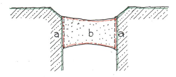
Abb.: Aufgaben des Abdichtungsmaterials a) Haftung an den Fugenflanken, b) Dichtheit des Materials
