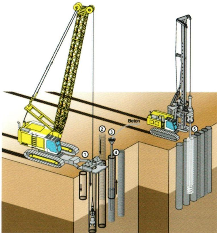
Abb. 1: Bohrpfahlherstellung
